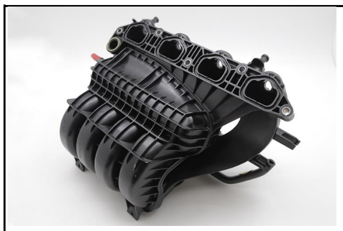
C11-2) Впускной коллектор - демонтированный
