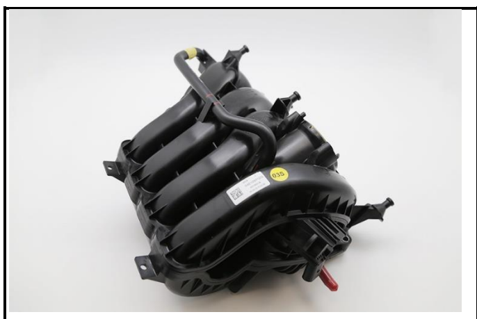
C11-1) Впускной коллектор - демонтированный
