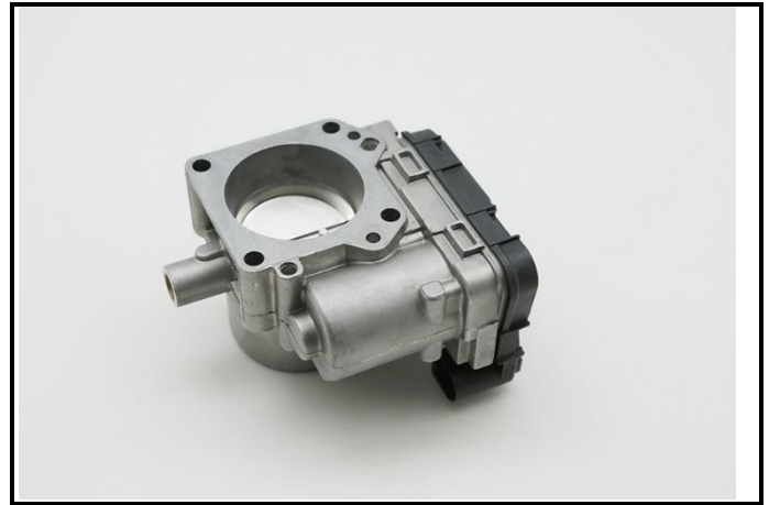
C11-4) Дроссельная заслонка - демонтированная
